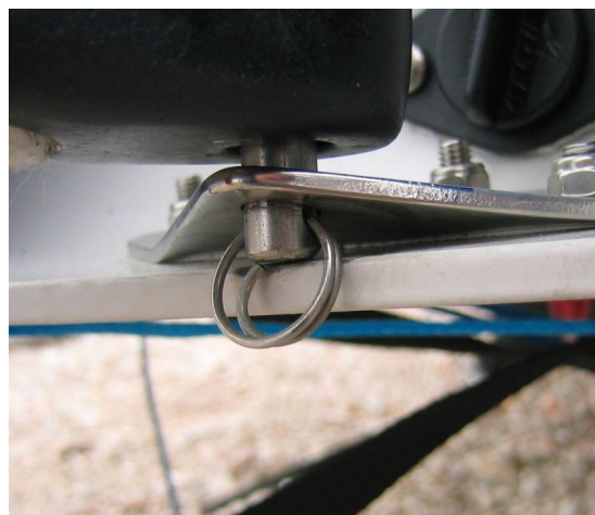
Abbildung 1: Sicherung des Ruderbolzens
